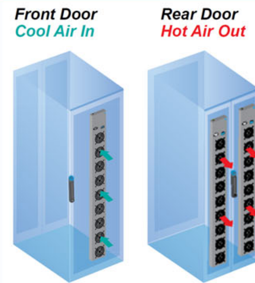
Door Mount Fan Panel
